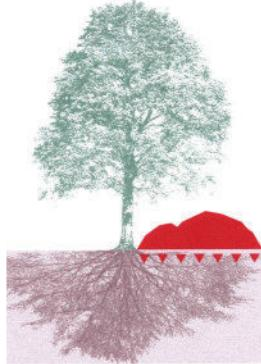
Impermeabilizzare il suolo all'aria e all'acqua, anche per costipamento, per superficie maggiore al 50% dell'area di sviluppo dell'apparato radicale.
