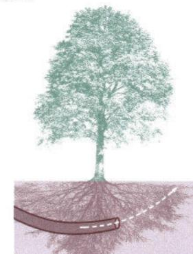
Evitare i lavori di scavo nell'area delle radici. L'uso di tubi a spinta danneggia meno le radici ed è da preferire a lavori di scavo.
